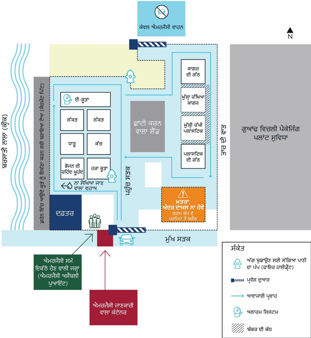
ਚਿੱਤਰ 2: ਨਿਯੰਤਰਣ ਉਪਾਅ ਲਾਗੂ ਕੀਤੇ ਜਾਣ ਤੋਂ ਬਾਅਦ ਐਰਿਕ ਦੀ ਸਹੂਲਤ। ਨੋਟ ਕਰੋ ਕਿ ਚਿੱਤਰ ਅਸਲੀ ਲੰਬਾਈ-ਚੌੜਾਈ ਮੁਤਾਬਕ ਨਹੀਂ ਬਣਾਇਆ ਗਿਆ ਹੈ।
