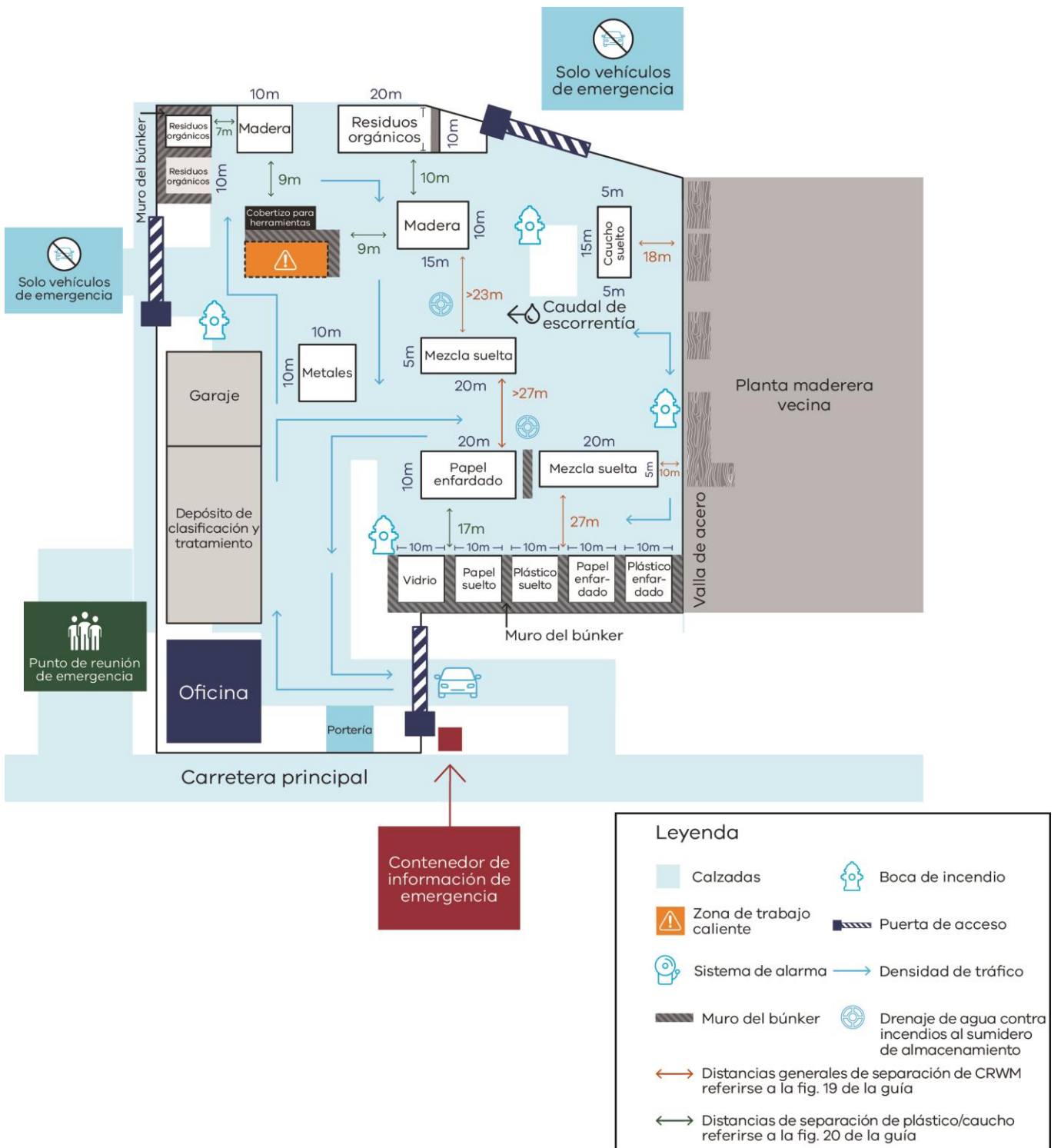
Figura 2: Instalaciones de Nicole tras la aplicación de los controles. Tenga en cuenta que la figura no está dibujada a escala.
